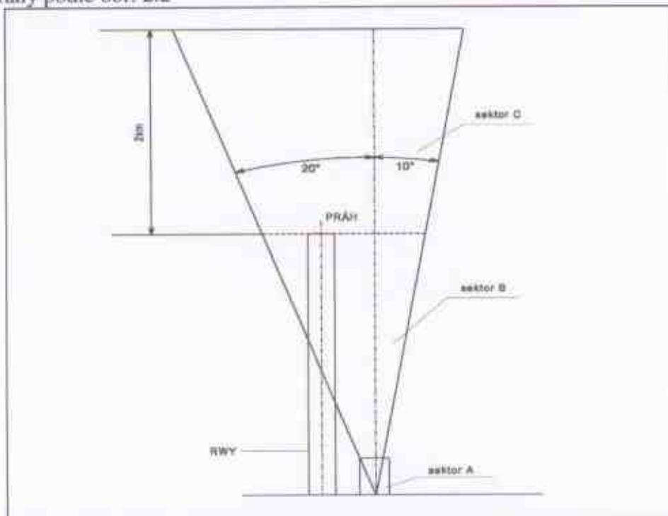
1.3 Ochranné pásmo nesměrového majáku (L, NDB) - je tvořeno třemi sektory - sektorem A, sektorem B a sektorem C viz obr. 3:
