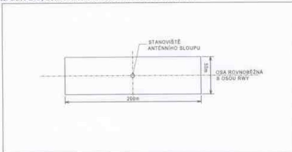
sektor A - má tvar obdélníku, v závislosti na typu zařízení podle obr. 1
